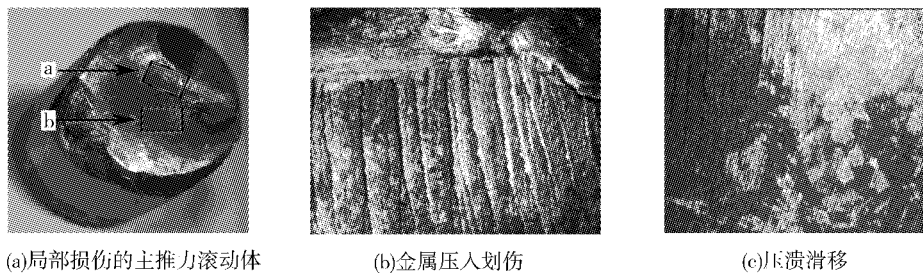
(a)局部损伤的主推力滚动体 (b)金属压入划伤 (c)压溃滑移 图7 主推力滚动体局部损伤形貌
